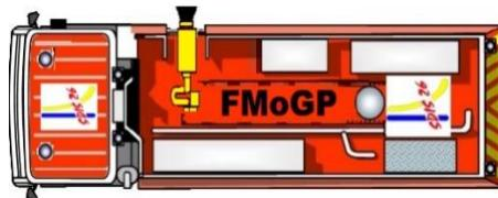
Le **FMoGP** a pour mission de projeter de l'eau ou de la mousse à partir de sa lance canon de toit (1000 à 4800 l/min) afin de réaliser une extinction, une temporisation ou une action de refroidissement à la mousse ou à l'eau de structures impliquées.
