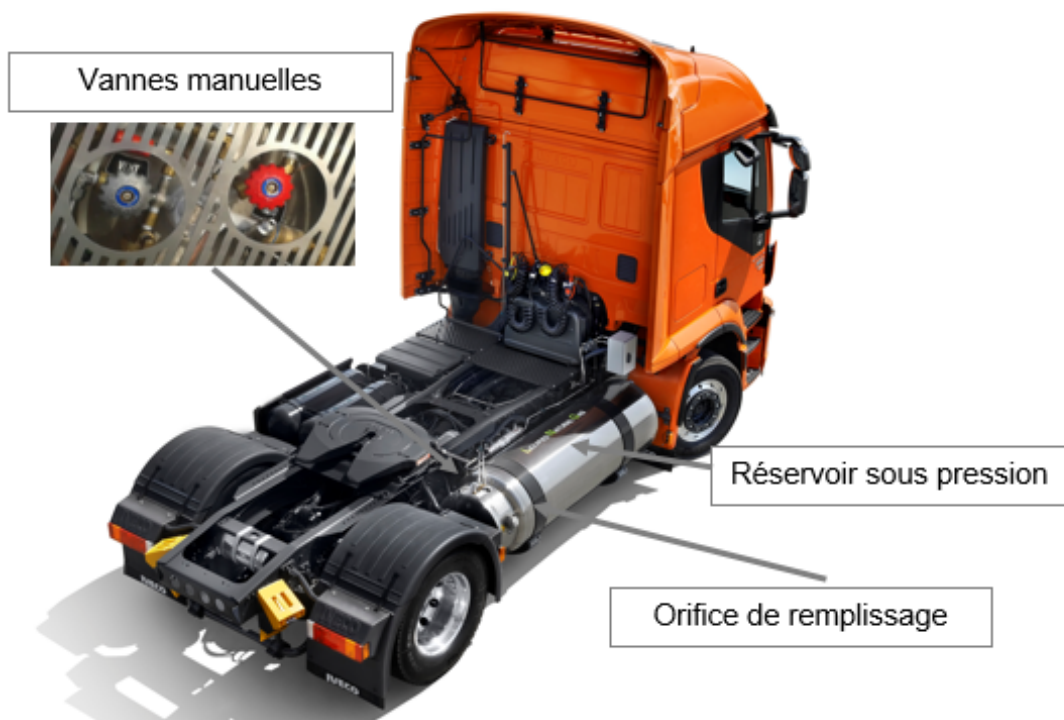
Equipements spécifiques d'un véhicule GNL © BPPM
