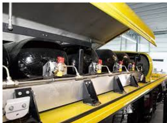
Réservoir GNC bus © Gaz-mobilité
