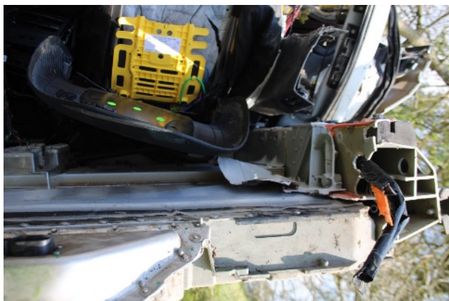
Exemple de gaine noire protectrice enveloppant les câbles orange.
