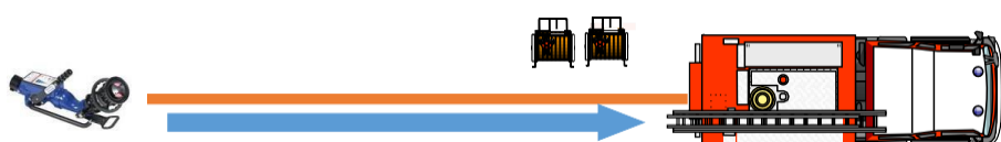
Établissement de la lance canon portable à - de 40 m et à - de 100 m
