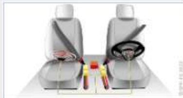
Figure 16-6 : exemple d'emplacement des cartouches pyrotechniques des prétensionneurs de ceinture
