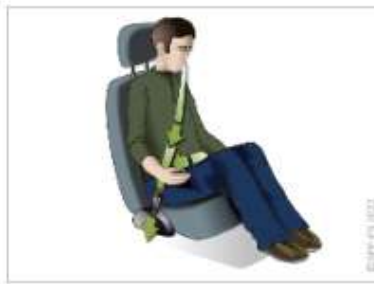
Figure 16-5 : principe de fonctionnement d'un prétensionneur de ceinture
