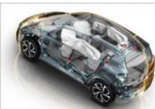
Figure 16-2 : emplacements possibles des airbags dans un véhicule
