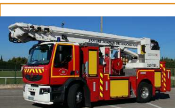
3 camions bras élévateur articulé (CBEA) de 30 mètres
