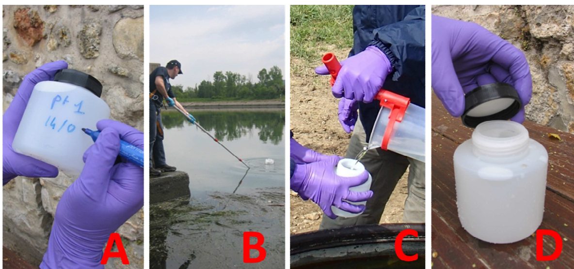
Illustration d'un prélèvement d'eau avec une canne télescopique
