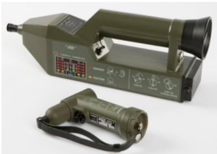
L'AP4C (Appareil Portatif de Contrôle de Contamination - 4 canaux) et le S4PE (Système Portatif de Prélèvement des Produits Persstants en vue de leur détection par Evaporation) permettent de détecter et de contrôler la présence, de 4 familles d'agent chimique phosphoré, azoté, arsénier, soufré :
