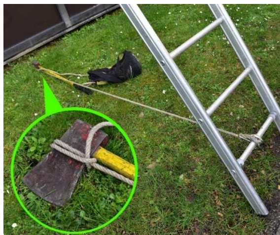
Au moyen d'une hache et d'une commande (nœud de cabestan).
