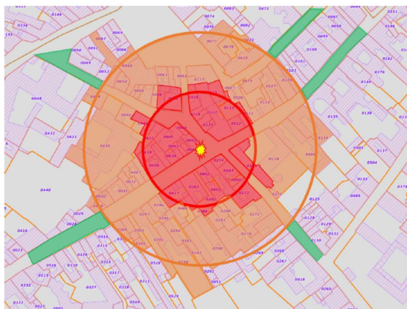
Exemple à l'échelle, d'un zonage opérationnel réflexe. La zone d'exclusion a un rayon de 50m et la zone contrôlée un rayon de 100m © Christophe Perdriset – DGSCGC
