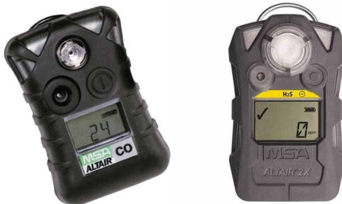
Le détecteur de CO équipe les sacs PSE. Il se déclenche en alarme basse à 20 ppm et en alarme haute à 200 ppm (pas de valeur chiffrée sur l'afficheur sur le modèle de gauche).
