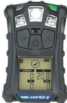
L'explosimètre étalonné sur le méthane (gaz de ville) est sensible à un panel de gaz (voir tableau des coefficients de correction) et possède deux alarmes. Ces alarmes correspondent à un pourcentage de la limite inférieure d'explosivité (LIE) : alarme basse = 10% / alarme haute = 40%.
