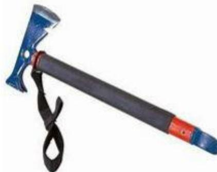
L'OFD, polyvalent, permet des actions de levier, de découpe et de forcement.
