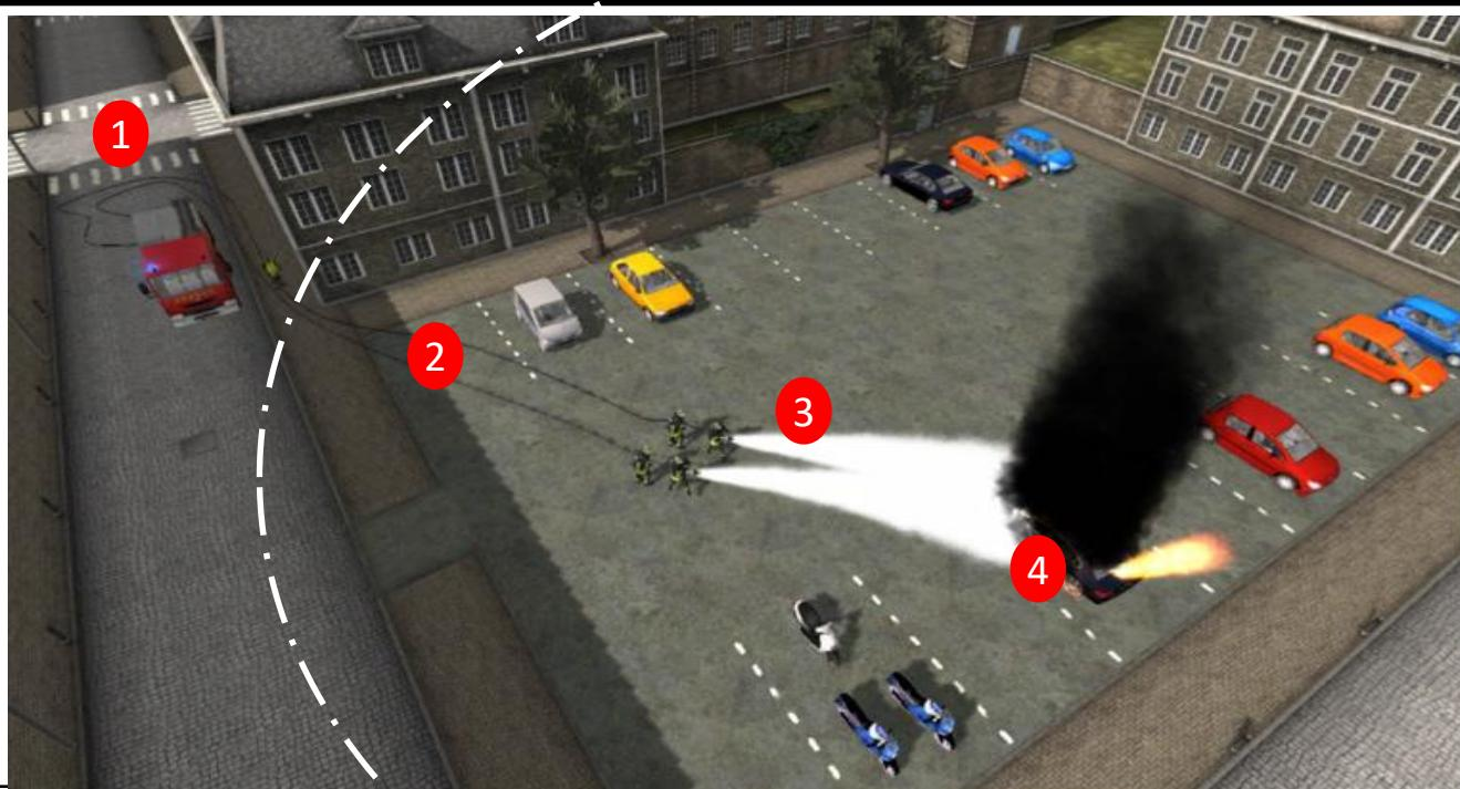
BAT1 et BAT2 établissent simultanément 2 LDV45 avec 3 tuyaux de 45/20m (60 m)
