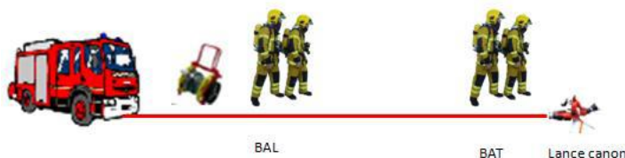
Schéma de principe de l'établissement d'une lance canon
