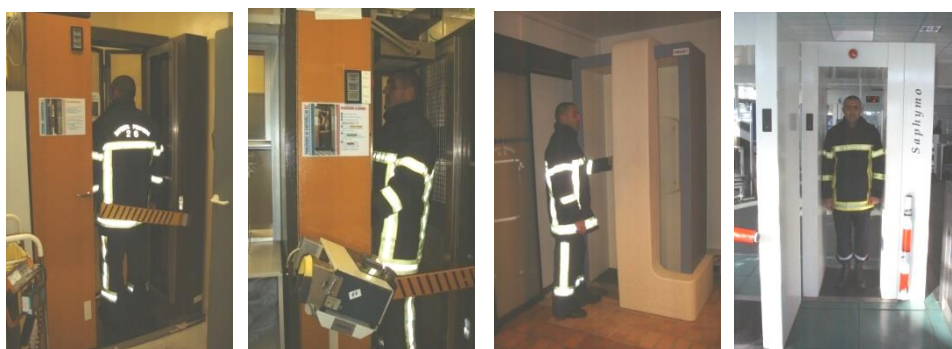
Passage des portiques C1, anthroporadiamètre et C3
