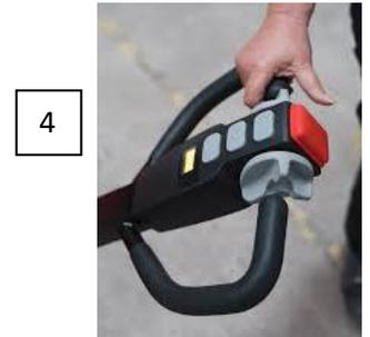
5. En cas d'encombrement ou de manœuvre délicate, vous pouvez faire avancer ou reculer le gerbeur avec le bras en position vertical en maintenant appuyer le bouton « TORTUE »
