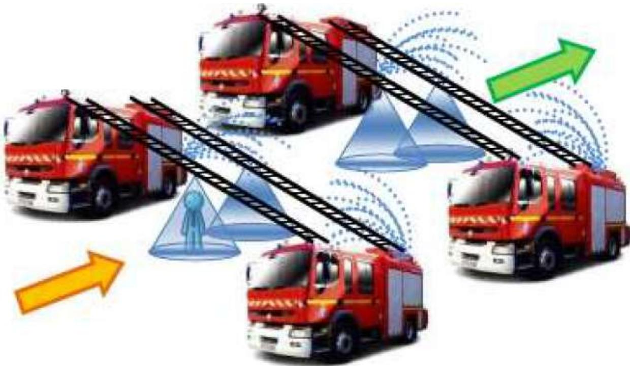
Le dispositif est mis en place de façon à ce qu'un égout soit au centre des 4 FPT. Ainsi l'eau de rinçage considérée comme contaminée s'écoule exclusivement dans la zone du tunnel, celle-ci ne contaminera pas le reste de la zone d'accès contrôlé.
