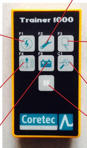
F3 : démarrage ou arrêt de l'appareil puis message « **connecter les électrodes** » cette fonction n'est active que si les électrodes sont raccordées à l'appareil
