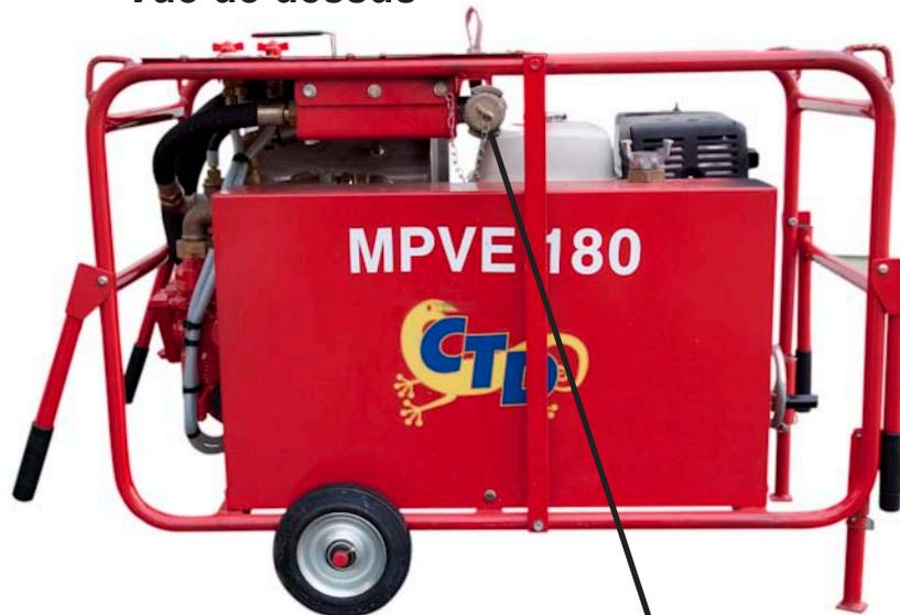
Raccord de refoulement d'émulseur DN40
