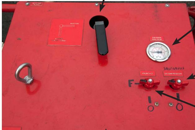
Manomètre de contrôle de pression (maxi 15 bars)
