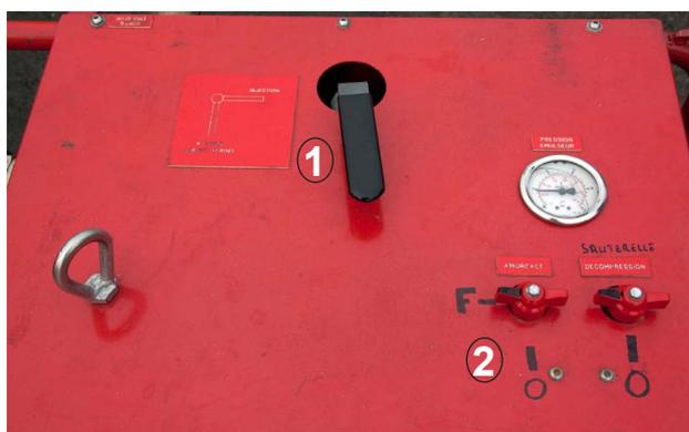
2 - Mettre la vanne d'amorçage en position ouverte
