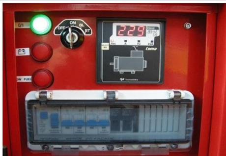
► Démarrer le groupe : maintenir la clé de démarrage quelques secondes en position ON avant de relâcher.
