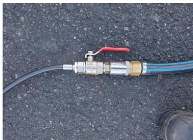
► Ouvrir la vanne du flexible d'air pour purger le dispositif.
