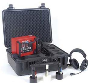
Les capteurs du vibraphone de l'ASB 8 sont des capteurs de vibrations. Ils permettent une écoute des vibrations transmises par les solides et sont pratiquement insensibles aux bruits ambiants.
