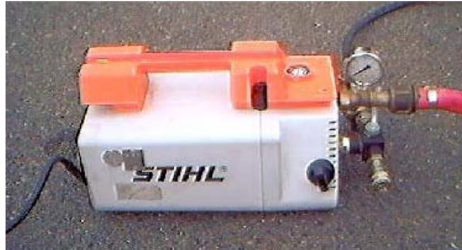
Le nettoyeur haute pression avec ses accessoires à 100 bars est utilisé pour nettoyer le matériel.
