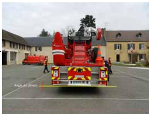
Un dispositif de correction de dévers assure en permanence l'horizontalité des échelons quelle que soit la position du parc.
