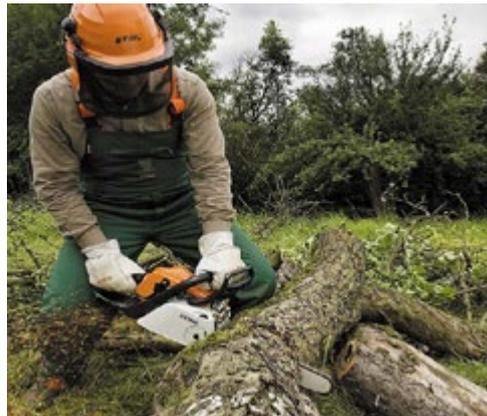
La position à droite ou à gauche du tronc devra être analysée par l'opérateur afin de ne pas être heurté par une pièce en mouvement pendant ou après la coupe.
