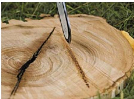
Travaillez exclusivement avec un graissage de chaîne en ordre de marche (particularité de certaines tronçonneuses avec un guide chaîne de 80 cm qui nécessite un graissage manuel toute les 5 à 10 mn).
