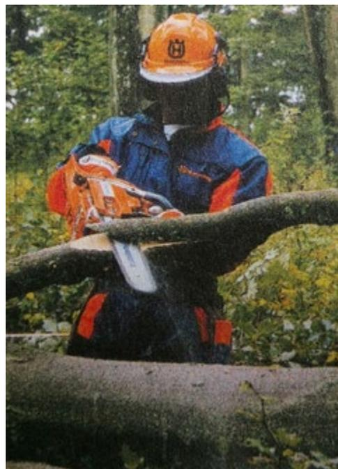
Lorsque le tronc ou la branche sont de faible section, il faut effectuer une coupe oblique depuis la fibre en extension jusqu'à la fibre en compression (du dos de la courbe au ventre).
