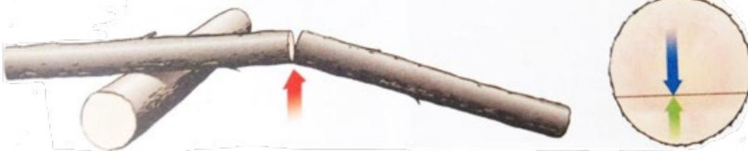
Commencer en réalisant un trait de coupe sur la fibre en compression (dessous) sur 1/3 de la section. Couper dans un deuxième temps la fibre en extension (dessus).
