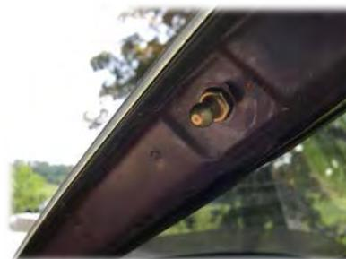
RETEX : il est arrivé lors d'intervention pour feu de véhicule que des fixations vérins de coffre cèdent et que les vérins se retrouvent projetés à plusieurs dizaines mètres du véhicule (effet missile)
