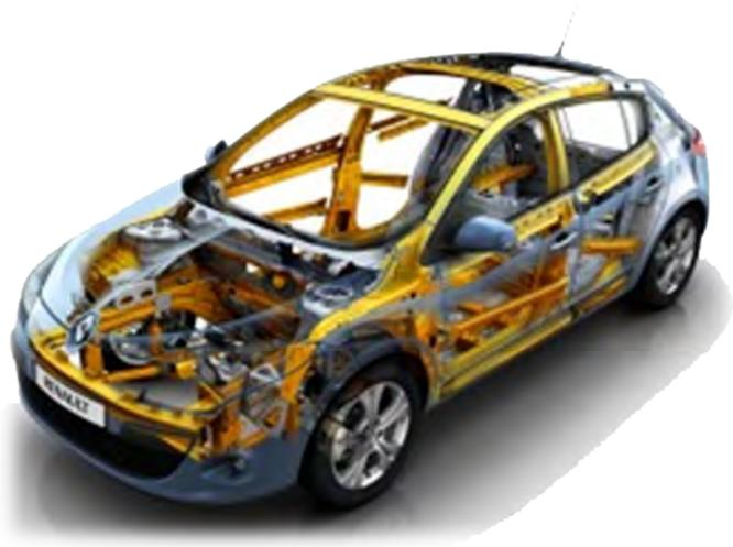
Le rôle de la structure est de se déformer, pour protéger, en absorbant l'énergie tout au long du choc par une déformation programmée.
