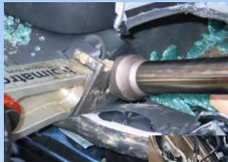
Si besoin de retirer le vérin pour faciliter l'extraction de la victime. Intercaler des coins à marier ou toute sorte de cales adaptées pour combler l'espace créé en bas du montant A. Cette action limitera l'effet de repli du bloc avant.
