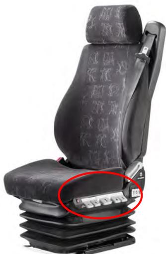
Bien souvent il est simplement nécessaire d'agir sur les commandes de réglages du siège pour figer les mouvements de ce dernier
