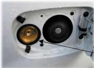
Orifice de remplissage spécifique GPLc
