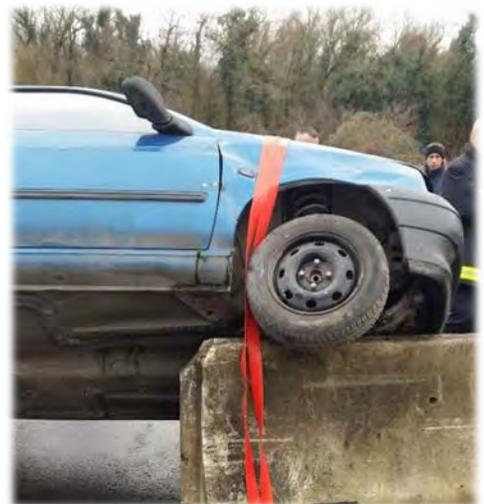
Le véhicule est solidarisé avec le muret central par la mise en place d'une sangle d'une sangle à cliquet, évitant ainsi tout risque de ripage. Bien entendu, d'autres éléments de stabilisation doivent être mis en œuvre.
