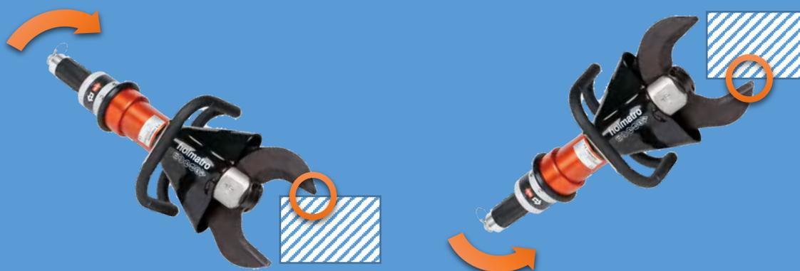
De même, l'angle de la face de coupe des lames fait naturellement vriller la cisaille sur la gauche d'environ 30°. Afin de contrer cette rotation, il est conseillé de commencer la découpe avec les lames orientées à 30° à droite de l'axe 0°.
