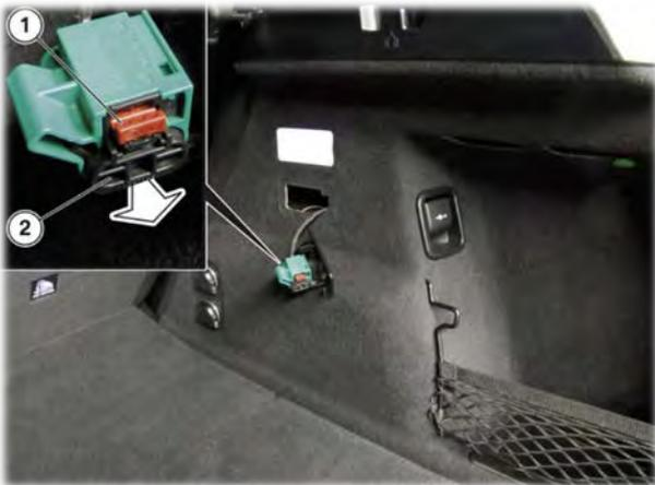
Boucle d'isolement BMW Série 2 PHEV
