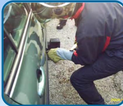
Vérifier que le verrouillage de la porte soit désengagé, dans le cas contraire la déverrouiller (si possible).
