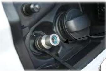
Orifice de remplissage spécifique GPLc
