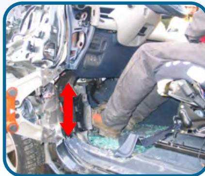
Positionner l'écarteur dans la fenêtre créée et ouvrir
