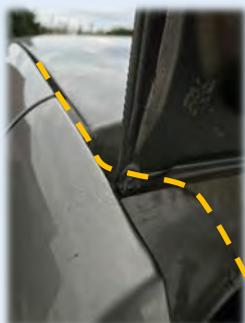
La zone de faiblesse est située de chaque côté du pavillon dans le sillon généralement protégé par de l'habillage plastique. Il est important de bien positionner la cisaille pour le bon déroulement de la technique.
