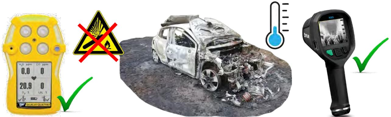
Le risque de **ré-emballement** thermique de batterie Li-ion est possible après un délai pouvant dépasser les 24h. Plusieurs solutions sont envisageables dont la première est d'isoler le véhicule dans un site éloigné de tout risque de propagation, la solution la plus efficace restant l'immersion des éléments Li-ion.
