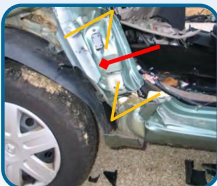
Positionner l'extrémité du vérin à la base du montant B avec ou sans la cale.
