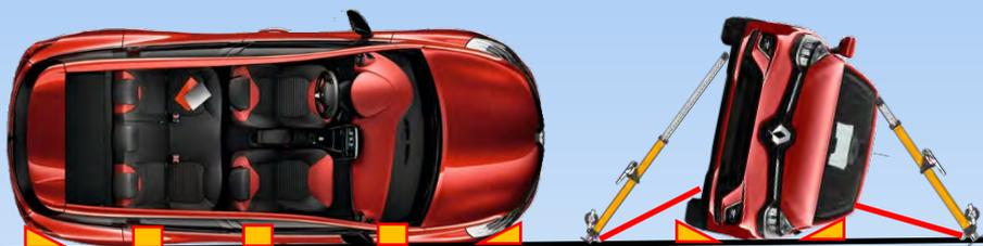
Le principal risque du véhicule retrouvé sur le côté est de basculer. Même caler contre un talus, un rail de sécurité ou au fond d'un fossé, il ne faut pas négliger la stabilisation.
