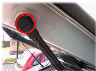
Chaque extrémité du vérin est constituée d'un système de rotule maintenu par un clip métallique ou plastique
