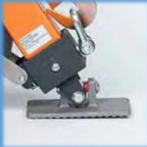
Placer la base du vérin sur une surface au sol plane et résistante. La pose d'un bastaing est recommandée lorsque le sol est non résistant (terre).
