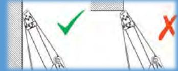
La tête à pincer doit toujours être sur une surface verticale du véhicule et en total appui
