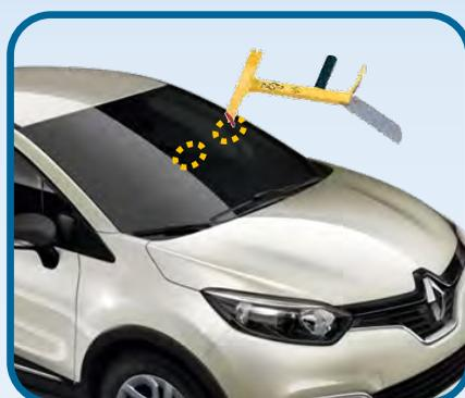
Repérer les deux zones de part et d'autre du bastaing qui serviront par la suite à passer la chaîne. Afin de travailler dans les meilleures conditions et éviter le ripage de l'écarteur, observer au maximum la perpendicularité (schéma ci-dessus)
