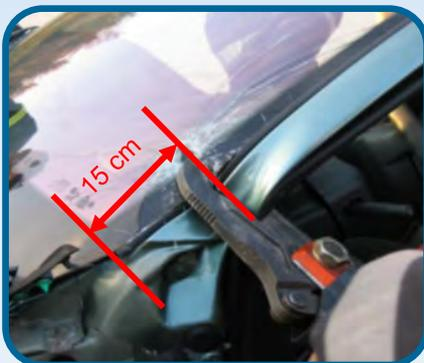
Réaliser une coupe partielle à la base du montant A, dans la zone des 20 derniers centimètres.
