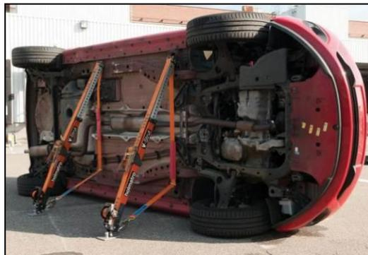
Les étais peuvent être positionnées indifféremment soit des deux cotes soit les deux du même côté dans ce cas un contre calage est positionné avant la mise en tension des étais.
