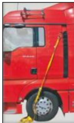
Stabilisation d'un véhicule en instabilité sur un muret :
