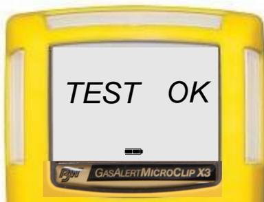
Validation du contrôle des capteurs
