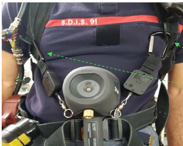
A l'aide des 2 mousquetons situés à l'extrémité des sangles rétractables, accrocher la caméra thermique sur les anneaux de support de matériel se trouvant sur les sangles de maintien de l'ARI.
