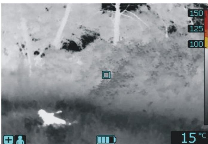
Le *mode recherche de personnes* est conçu pour garantir un haut niveau de contraste de l'image afin de faciliter la recherche de personnes à secourir en extérieur, dans des bâtiments, plans d'eau ou lors d'accidents de la route.
