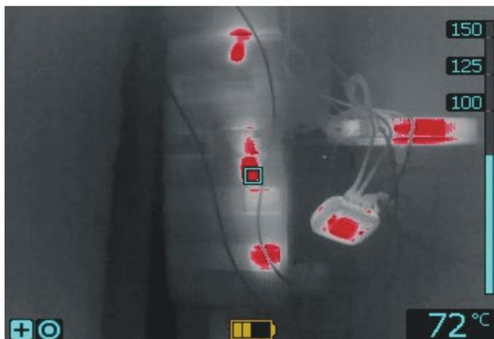
Le **mode recherche de points chauds** permet de détecter les points chauds ou de foyers résiduels (détection d'un court circuit) subsistant après l'extinction d'un incendie.
