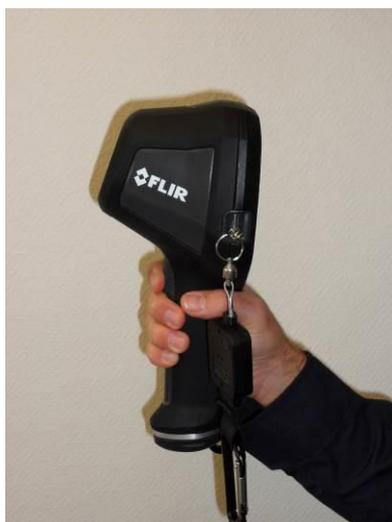
➤ Appuyer fermement sur la **gâchette** pour prendre une photo. L'affichage d'une icône à gauche de l'écran confirme l'enregistrement de la photo.
