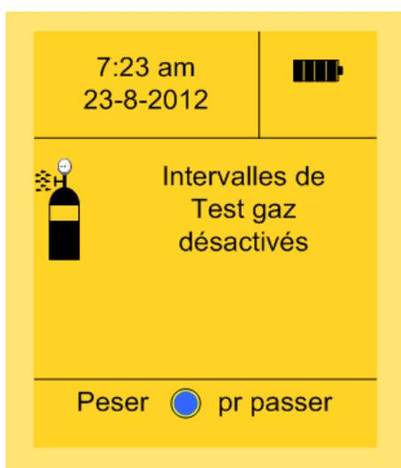
L'intervalle de test gaz est désactivé, les mises à zéro automatique des capteurs H<sub>2</sub>S, CO et LEL étant désactivées pour laisser apparaître toutes dérives de ces derniers.
