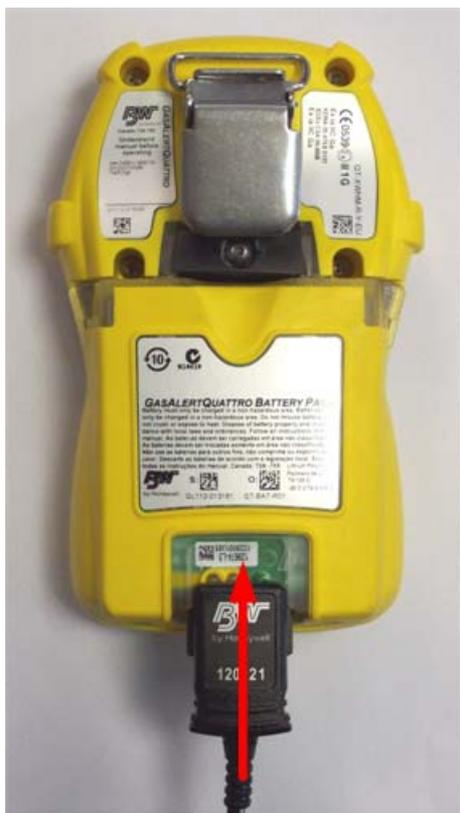
Pour recharger la batterie insérez le connecteur comme indiqué par la flèche.
