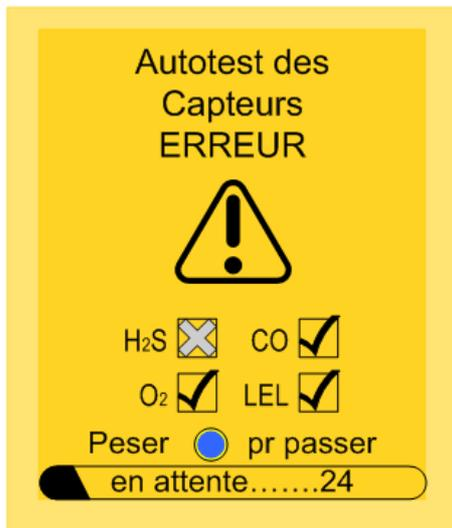
Echec de l'autotest des capteurs pendant le démarrage.
