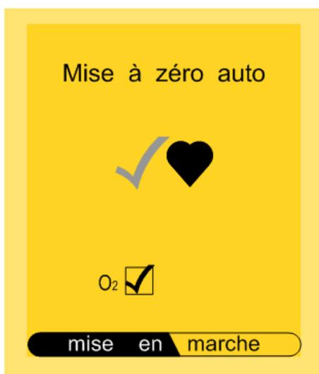
Validation de la mise à zéro du capteur O<sub>2</sub>.
