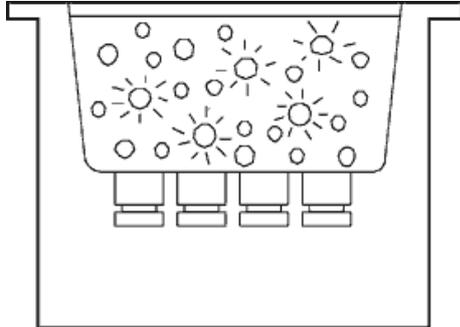
Les ondes ultrasonores se propagent dans le liquide de la cuve et produisent des pressions alternativement hautes et basses
