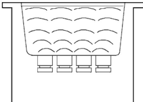
Lors de la phase suivante, de haute pression, les petites bulles implosent et libèrent de grande quantité d'énergie. Ces implosions font l'effet de petites brosses, elles travaillent dans n'importe quelle direction, et nettoient toutes les surfaces possibles : les creux, les replis et les trous des objets à géométrie complexe
