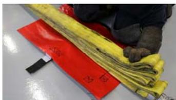
Le raccord du tuyau doit être correctement orienté, du côté de la sangle de serrage, dépassant de 10 cm du manchon.
