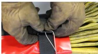
Tirer sur la sangle en passant au travers de l'attache. Verrouiller celle-ci en faisant attention au bon positionnement de la cordelette de rappel.
