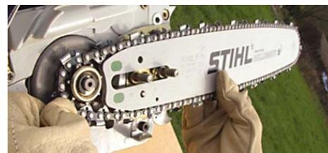
Prendre le dispositif complet, mettre la chaîne sur le pignon et faites glisser le guide sur le goujon de fixation.
