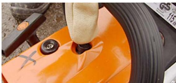
Si la tronçonneuse possède un décompresseur, pressez-le Bouton.
