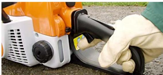
Dès que le moteur a démarré et tourne. Touchez brièvement la gâchette avec l'index. Le levier de commande universel revient au réglage normal au ralenti.
