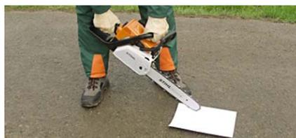
Vérifier la lubrification de la chaîne. Gaz à fond, un filet d'huile doit apparaître sur une surface claire.
