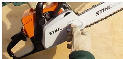
Tourner l'écrou à ailette jusqu'à ce que le couvercle bute sur le carter moteur.
