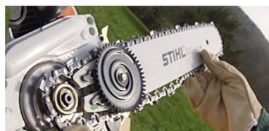
Prendre le dispositif complet, mettre la chaîne sur le pignon et faites glisser le guide sur le goujon de fixation.
