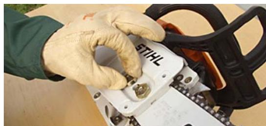
Replacer le carter de pignon sur le bloc moteur. Serrer le (les) écrou(s) à la main de manière à ce que le dispositif de coupe ne bouge pas lors de la tension de chaîne.
