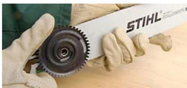
Tourner la molette de réglage montée sur le guide dans le sens horaire jusqu'au bout.
