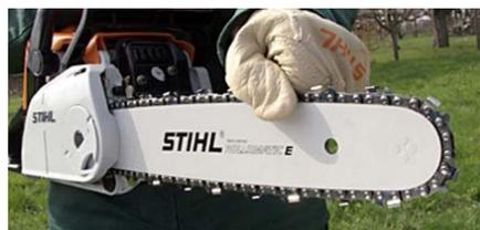
S'assurer que la chaîne est bien dans la rainure du guide. La chaîne doit glisser facilement.
