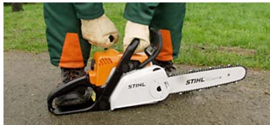
Tirez (**verticalement**) lentement la corde du lanceur jusqu'à sentir une résistance. Tirez alors fermement jusqu'au point de compression du moteur. (il tousse)
