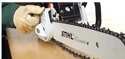
Tourner la molette de tension vers l'avant. Les entraîneurs doivent désormais rentrer dans la rainure du guide. **Serrer l'écrou.**
