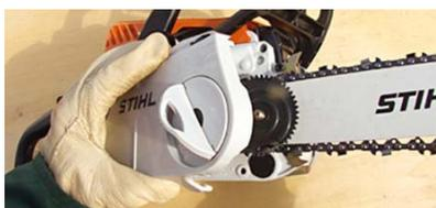
Replacer le couvercle de pignon sur le bloc moteur en prenant soin de mettre toutes les pattes dans les trous prévus.
