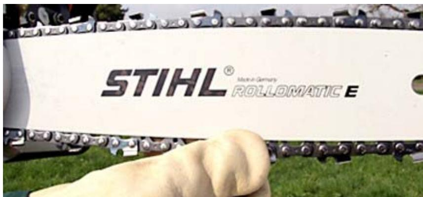
A froid, la chaîne doit porter sur la partie inférieure du guide-chaîne et lorsque le frein de chaîne est desserré, il doit être possible de la faire glisser sur le guide-chaîne en la tirant à la main.
