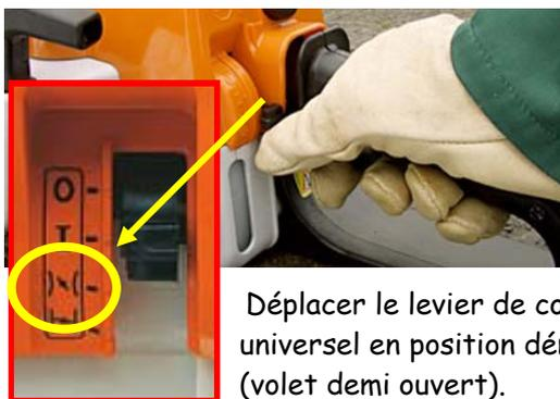
Déplacer le levier de commande universel en position démarrage (volet demi ouvert).
