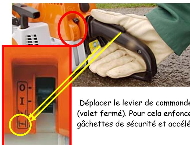
Déplacer le levier de commande universel en position starter (volet fermé). Pour cela enfoncez simultanément les gâchettes de sécurité et accélérateur.
