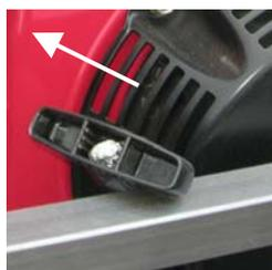
Vérifier que le levier de commande hydraulique soit en position fermé (OFF).
