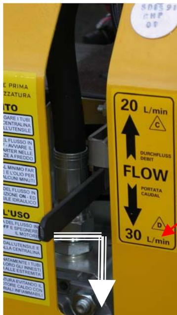
Positionner le Levier de commande de débit du groupe hydraulique sur 30L/min.
