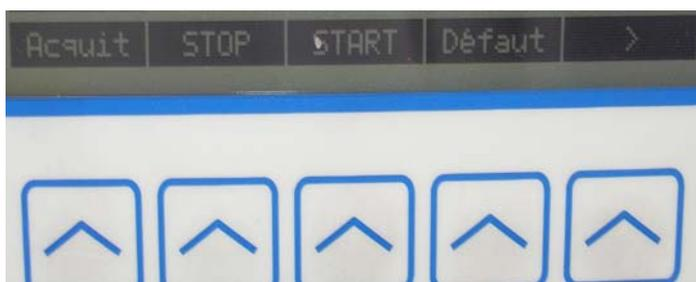
**START** Cette touche permet de lancer le groupe électrogène, un appui permanent active le préchauffage puis lance le démarreur.
