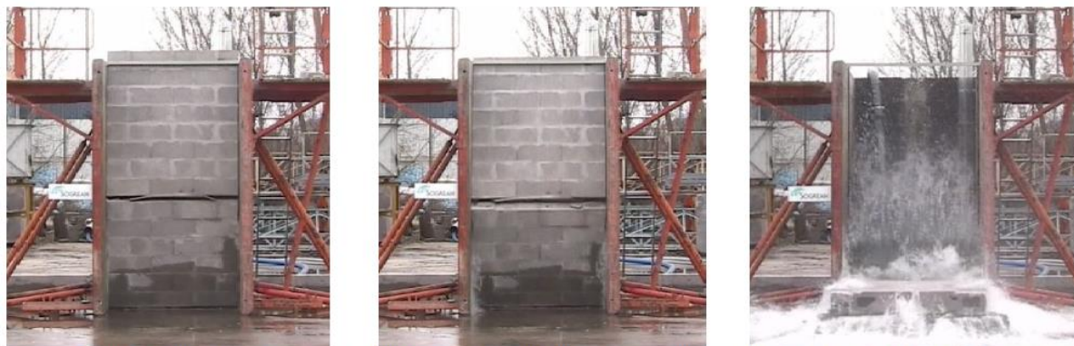
Figure 7 : rupture d'un mur maçonné non charné verticalement sous l'effet de la pression hydrostatique (source Mairie de Toulouse, Artelia)
