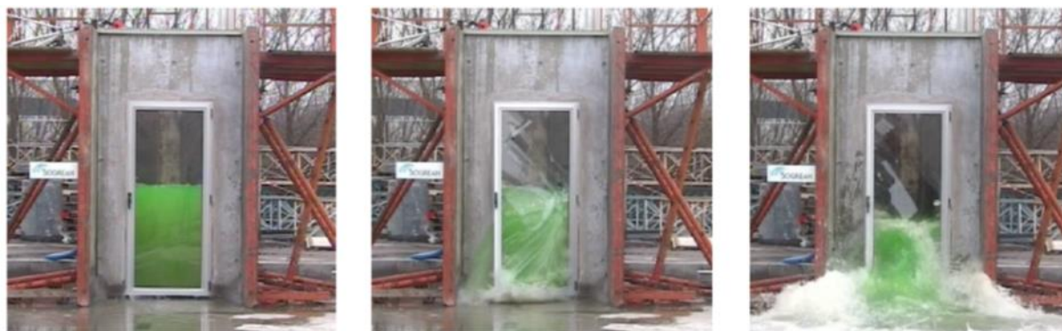
Figure 8 : rupture d'une porte de béton sous l'effet de la pression hydrostatique (source Mairie de Toulouse, Artelia)
