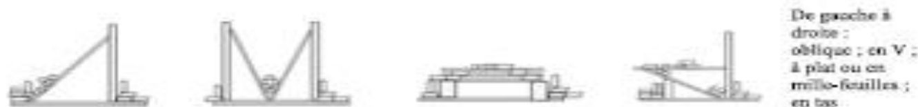
Figure 36 : Les 4 modèles d'effondrements (FEMA URBAN SEARCH AND RESCUE, 2011)
