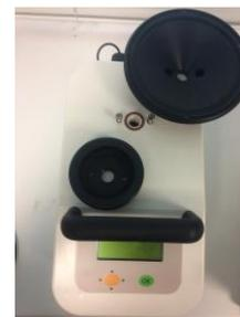
**UTILISATION** : le PA 1000 sert à collecter les aérosols présents dans l'atmosphère. Sur opération, le PA 1000 est positionné au point de prélèvement défini par le chef CMIR pour réaliser le prélèvement de particules solides pour des analyses de radioactivité.
