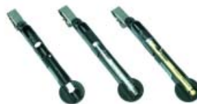
Tube à diffusion à indication directe dans son support
