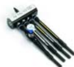
Impacteur avec adaptateur dans l'Aerotest Simultan
