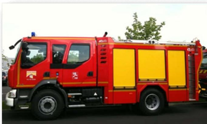
Armé au minimum de 6 sapeurs-pompiers, il dispose d'une réserve minimale de 2000 litres d'eau ainsi que d'une réserve d'émulseur (solution aqueuse).
