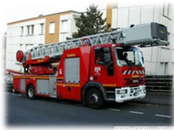
Armées de 2 à 3 sapeurs-pompiers, les échelles permettent d'atteindre principalement des hauteurs de 18 à 30 mètres et plus. Elle peuvent comporter une nacelle ou une plateforme. Elles sont utilisées pour attaquer les incendies en position dominante, enrayer la propagation des flammes aux niveaux supérieurs ou pour effectuer des sauvetages de personnes coincées dans les étages.
