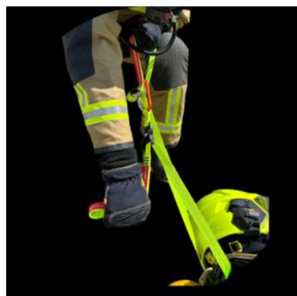
Pour réduire la longueur de la sangle tirer sur la poignée côté came à griffe, inversement pour rallonger la sangle appuyer sur la came à griffe qui permettra de faire coulisser la sangle à la longueur souhaitée.
