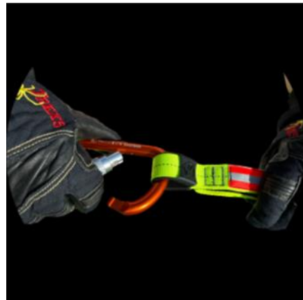
Entourer le montant ou l'échelon et le point fixe. Connecter le mousqueton dans le pontet noir.
