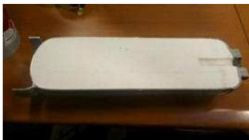
L'intérieur d'une bouteille d'acétylène
