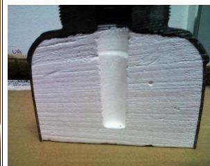
L'intérieur d'une bouteille d'acétylène
