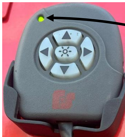
Projecteurs sous tension
