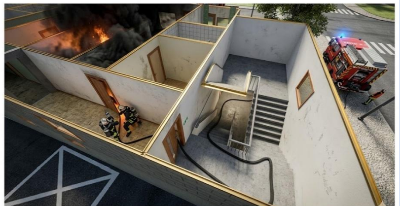
Illustration n°1 : La première porte d'accès est refermée sur le tuyau afin de minimiser l'apport d'air.
