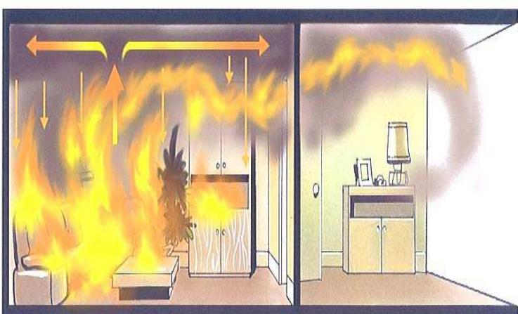
Cet effet va causer une augmentation substantielle de la température de la fumée qui va à son tour augmenter la température des objets au travers d'un rayonnement plus important.
