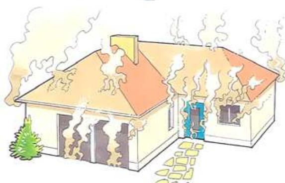
Le volume est rempli de fumées chaudes, en surpression. Les fumées à l'intérieur du volume ne peuvent pas s'enflammer par manque d'air.
