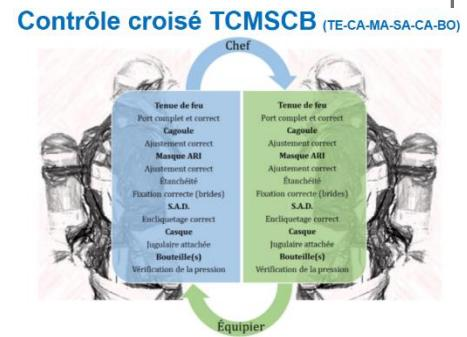
**!** Afin de garantir une étanchéité efficace et éviter toute fuite de nature à mettre en danger le porteur, **la pièce faciale doit être portée en contact direct sur une peau rasée**, cagoule par-dessus le masque.
