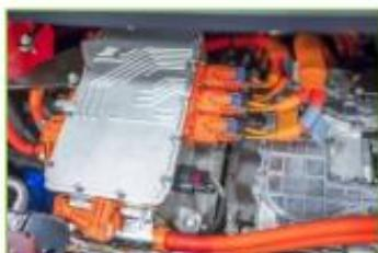
**La présence de câble haute tension** au-dessus de 60 V courant continu ou 30V courant alternatif. Ils sont généralement de couleur orange.
