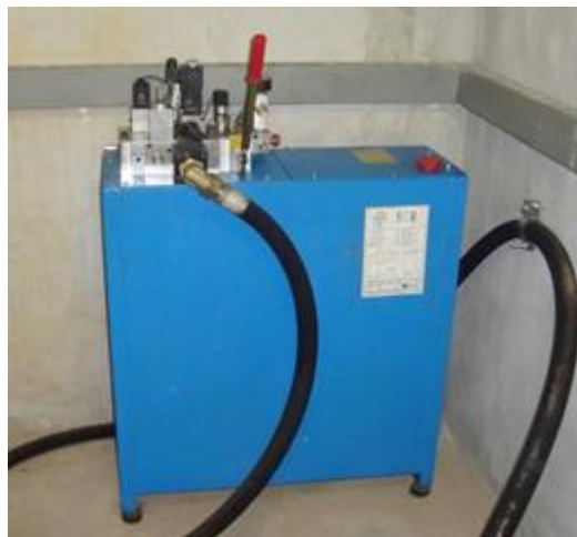
Exemple de centrale hydraulique
