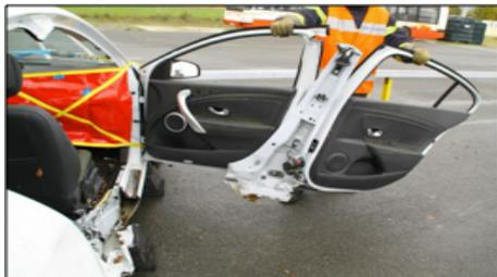
Utiliser les charnières de la porte avant pour replier l'ensemble portes et montant vers l'avant
