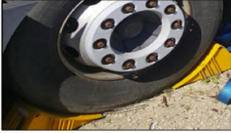
**1** Positionner des cales de roue (de préférence sur roues non directrices)
