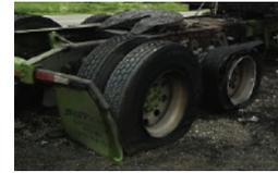
Lors d'un incendie de véhicule (notamment les PL et bus) l'éclatement d'un pneu peut donc s'avérer dangereux pour les SP (souffle, projection, impact auditif). Attention notamment aux éclatements de pneus « à retardement », qui peuvent survenir après l'extinction complète du véhicule.
