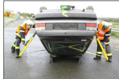
Les crochets des deux étais peuvent aussi être joints un à un
