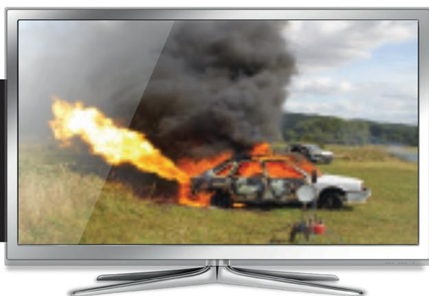
Le déclenchement de la soupape pour un véhicule sur ses roues entrainera une torchère en phase gazeuse cyclée.
