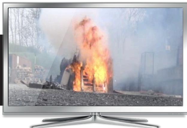
L'emballage thermique d'une batterie LMP se traduit par des flammes très denses avec émission de fumées conséquente, accompagnées de projections de particules de métal en fusion.
