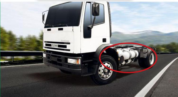
Sur les PL, les réservoirs GNC sont généralement situés sur les côtés (bas de caisse).
