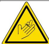
Risque de coupure en cas de mauvais positionnement des protections
