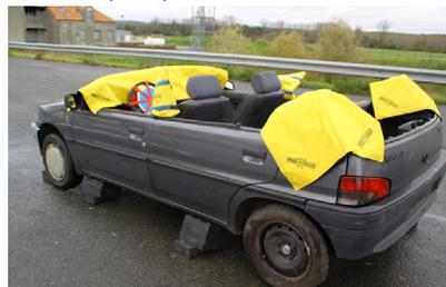
Selon la même technique il est possible de réaliser des relevages et coupe du pavillon selon des axes et montant du véhicules différents en fonction de la situation rencontrée : 3/4 pavillon, coupe latérale etc etc...
