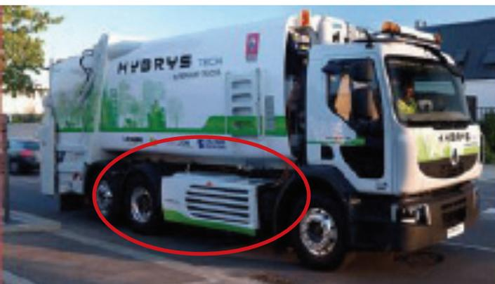
Sur les PL, les packs batteries sont généralement situés sur les côtés (bas de caisse).
