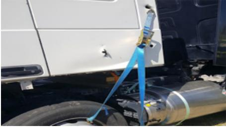
**2** Solidariser la cabine et le châssis à l'aide des sangles à cliquet (annuler l'effet suspension de la cabine)
