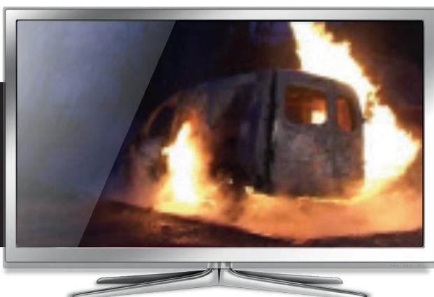
L'emballage thermique de la batterie entrainera le dégagement de gaz inflammables. Le feu de VeH/VE s'apparentera donc à une fuite de gaz enflammée.
