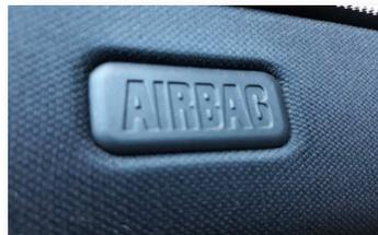
La position approximative d'un airbag dans le véhicule est reconnaissable, en fonction du modèle, au marquage **SRS AIRBAG**, **AIRBAG**, **SRP**, **SIPS BAG**, **SIR**, **HPS**, **IC**, **WC**, **RS**...
