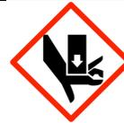
**Risque mécanique** (écrasement : en cas de mauvaise utilisation des cales : non respect des capacité de levage, contre calage instable, etc.)
