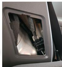
Attention une deuxième batterie peut être présente dans le véhicule. La mise en marche des feux de détresse après débranchement ou section des câbles BT peut être réalisée pour une vérification
