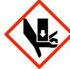
Risque mécanique (écrasement : en cas de mauvaise utilisation des coussins : non respect des capacités de levage, contre calage instable, etc.)
