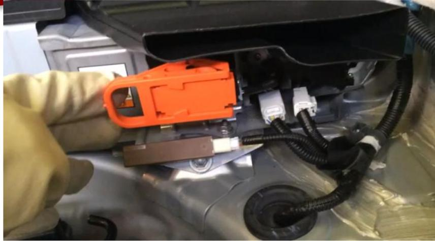
*Adéquation avec le NIO DGSCGC : «La source d'énergie de traction sera neutralisée par la coupure du contact, la neutralisation de la batterie 12v (ou 24v) et le retrait du plug service **quand cela est possible** ou à défaut de l'ensemble des fusibles.*
