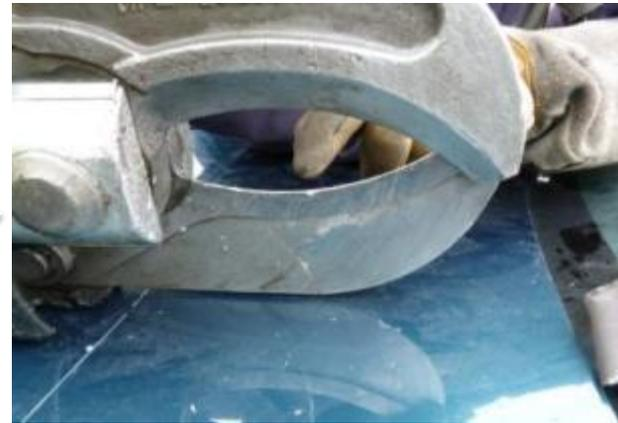
*Photos d'essais de coupe d'échantillon de montant B
