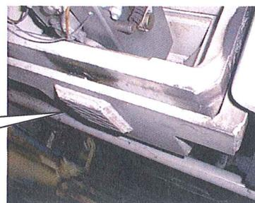
Ces points d'appui ne permettent pas de lever et caler au même endroit. Les seuls points de calage utilisables sont les autres points de levage.
